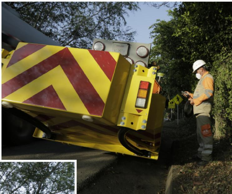
*Mediante un control, el operario maniobra el atenuador de impacto para ubicarlo de la mejor manera en el vehículo, con el fin de amortiguar algún posible golpe de otro carro y no cause daño a los trabajadores.*
