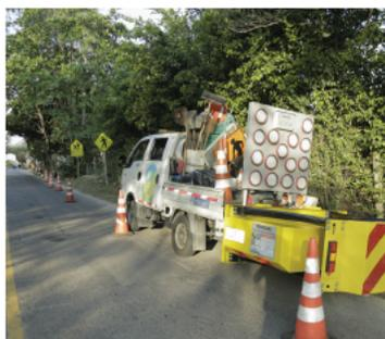
El vehículo con atenuador de impacto protege al personal que trabaja en la vía delante de él, en caso de que otro automotor colisione con el atenuador.
