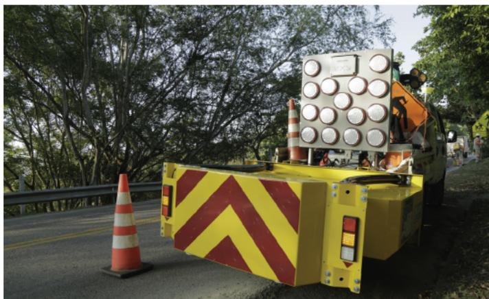
Con la instalación de atenuador de impacto en la parte trasera de los vehículos de mantenimiento y operación, Autopista Río Magdalena busca proteger la vida e integridad física de sus colaboradores que laboran en la vía.
