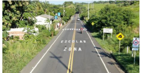
Se utilizan las señales de piso u horizontales, como "las cebras" que se demarcan sobre la carpeta asfáltica para indicar que ese es un paso seguro para los escolares.
